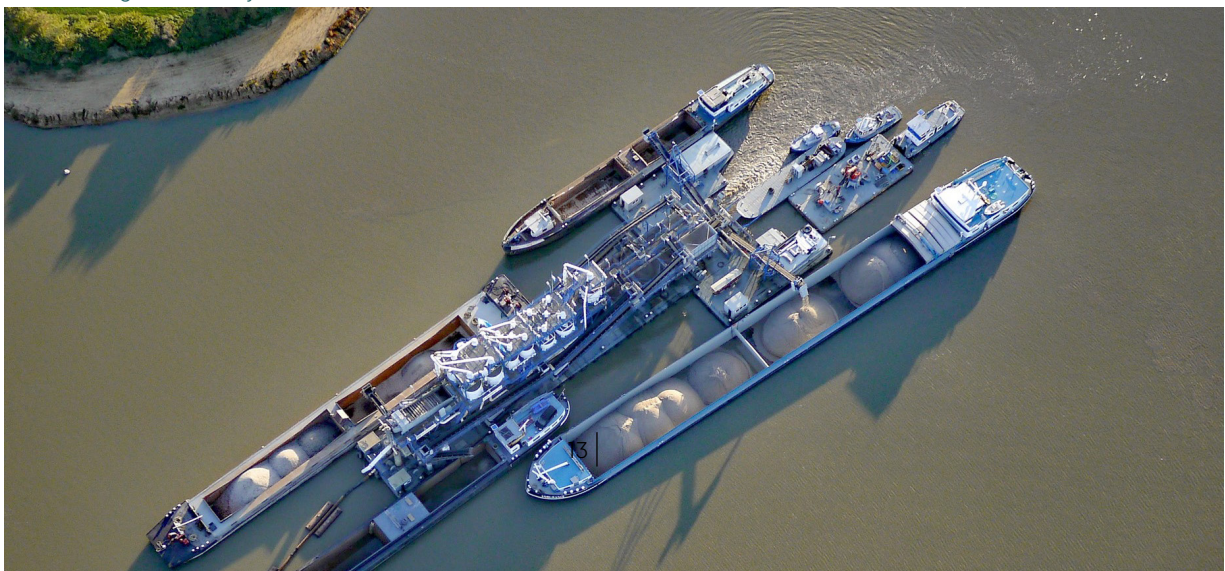
Zandwinning met een drijvende installatie, Teunesen
